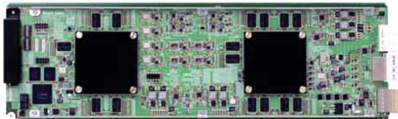
MD8000 - UVTX-2022 – 4 Port HD/SD/DVB-ASI Universal Video TX Module
